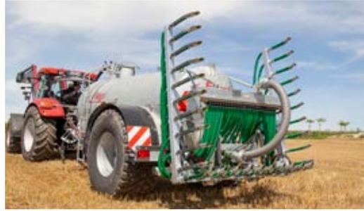
Abb. links: Mit dem anpassungsfähigen Federstahl gelingt eine Ausbringung mit bester Bodenanpassung.
