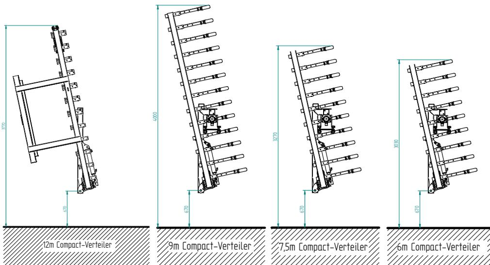
Abb. links: Der Schleppschuhverteiler Compact ist in insgesamt fünf Breiten von drei bis zwölf Metern erhältlich.
