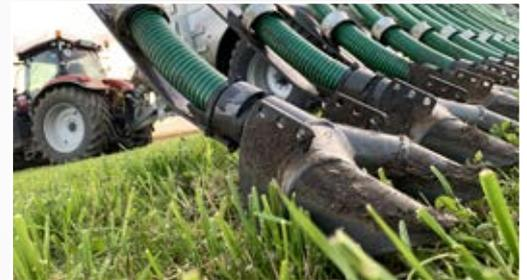
Fliegl TWIN ist eine Y-förmige Schleppschuhdüse. Sie splittet den Güllefluss, halbiert so die Güllemenge pro Gülleband und verdoppelt gleichzeitig die abgelegten Güllebänder.
